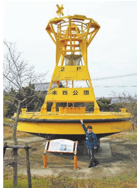
写真3 本四連絡橋近傍に設置された円盤型航路浮標 (直径5m)
