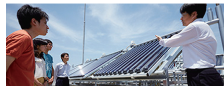
写真1 工学部G棟屋上で実施した太陽熱温水器による熱回収実験
