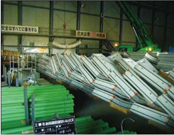
震災による被災状況 ～セグメントヤードのセグメントの一部が倒れ損傷～
