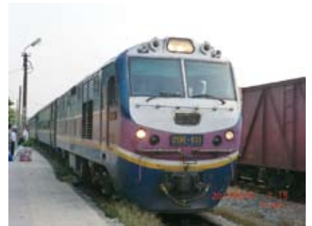
ベトナム・ハノイ～ホーチミン間を運行し ている特急列車 ハノイ～ホーチミン間1600kmを約30時間で 運転している
